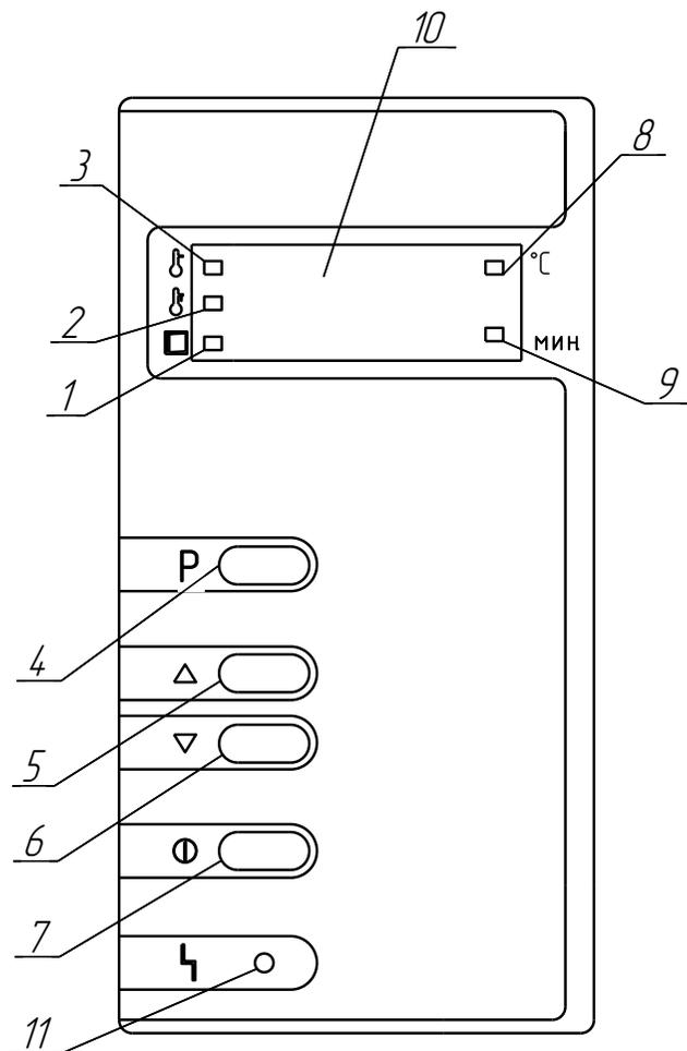
Рисунок 2 – Расположение органов управления стерилизатором на блоке управления
